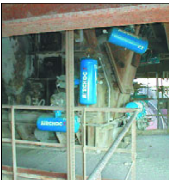
Figure 2 – Airchoc® 5 en situation sur une tour de préchauffage Airchoc® 5 installed on a preheating tower
