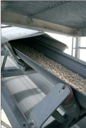
Le capot, plat et avec des trappes de visite, évite les envolées de poussières et le contact des matériaux avec le milieu extérieur
